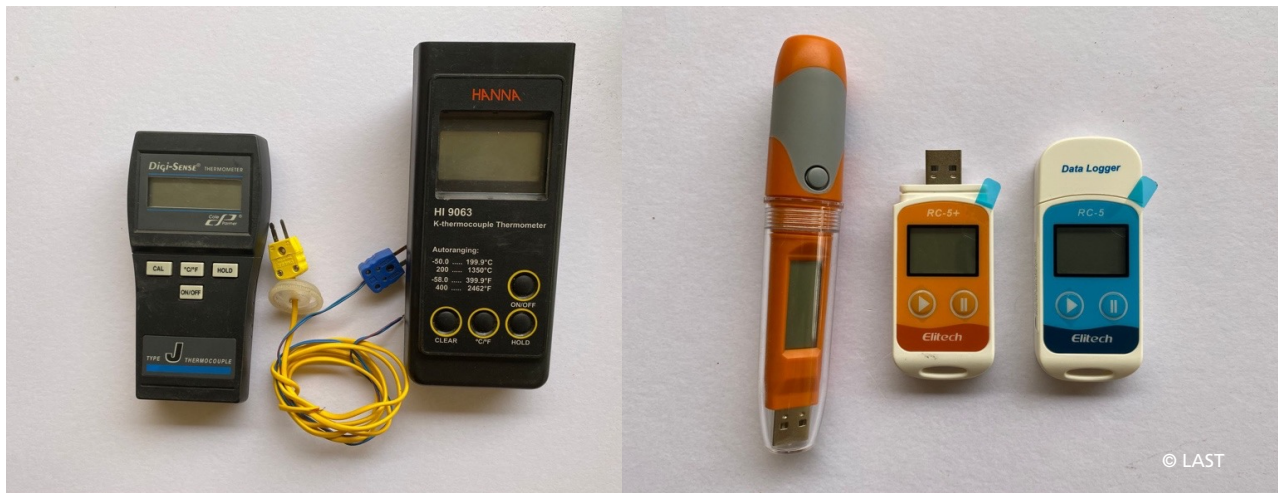
Figura 41. Termocoplas y datalogger para el monitoreo térmico de anidaciones de tortugas marinas. (Fuente: Didiher Chacón).
