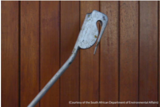
Figura 9. Cortador de aparejo tipo pico de ganso con extensión acoplada, recomendado por la CMS para liberación de megafauna menor. Fuente: Hamer y Milton (2020).
