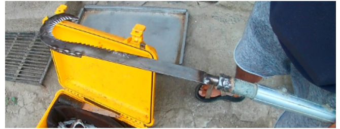
Figura 10. Punta de corte en forma de "J" unido a un tubo extensor, desarrollado por guardaparques del PNM para liberar ballenas mediante el sistema de romper el aparejo jalando con el bote.
